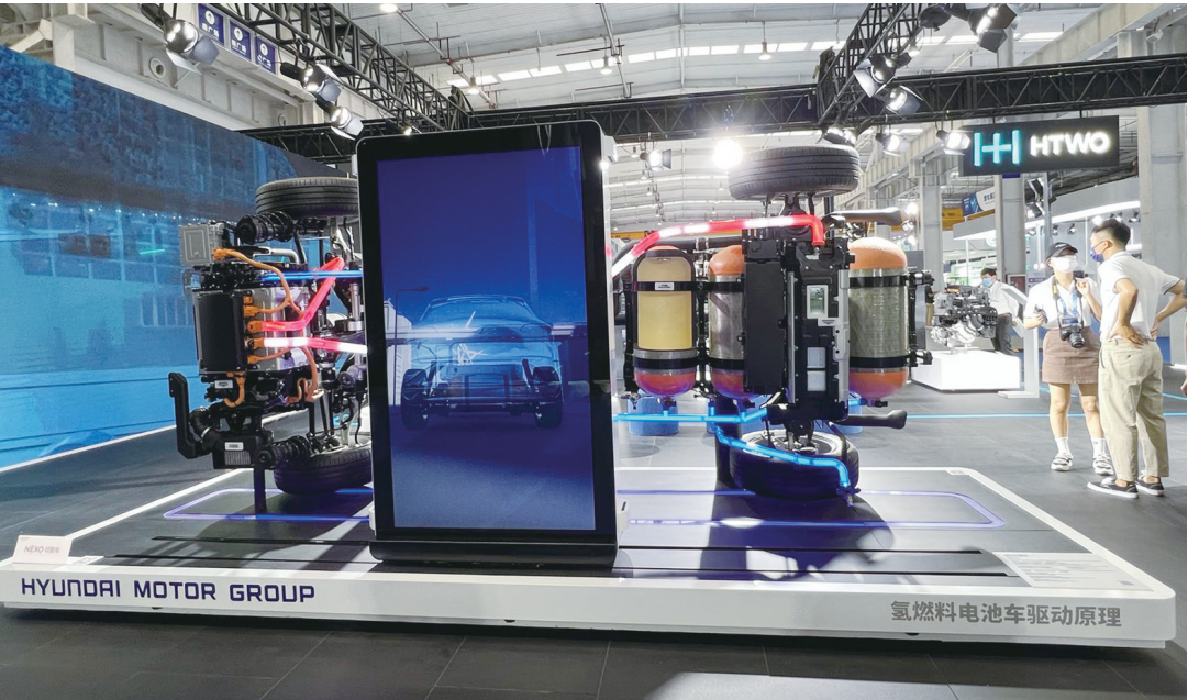
一款氢燃料电池车拆解展示,其中橘黄色装置为3个储氢瓶。新华社发
