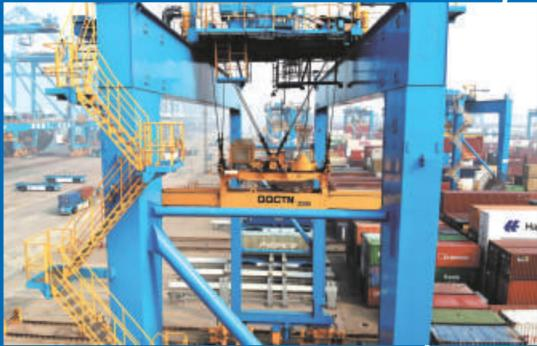
山东港口青岛港全自动化集装箱码头创新应用了氢动力自动化轨道吊。
