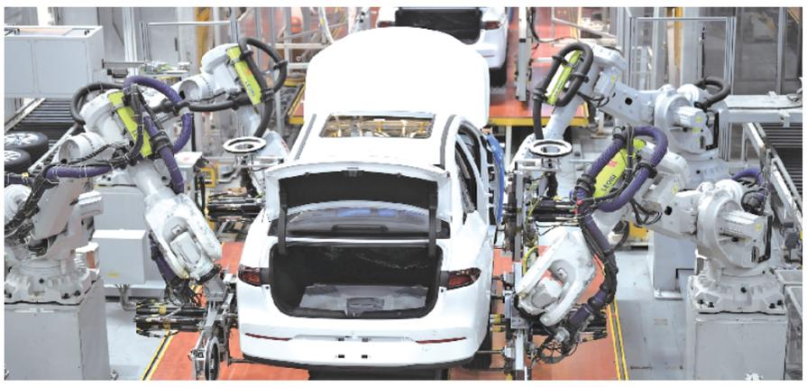
2月24日,在广汽埃安新能源汽车股份有限公司总装生产线,机器人手臂在安装汽车轮胎。新华社发
