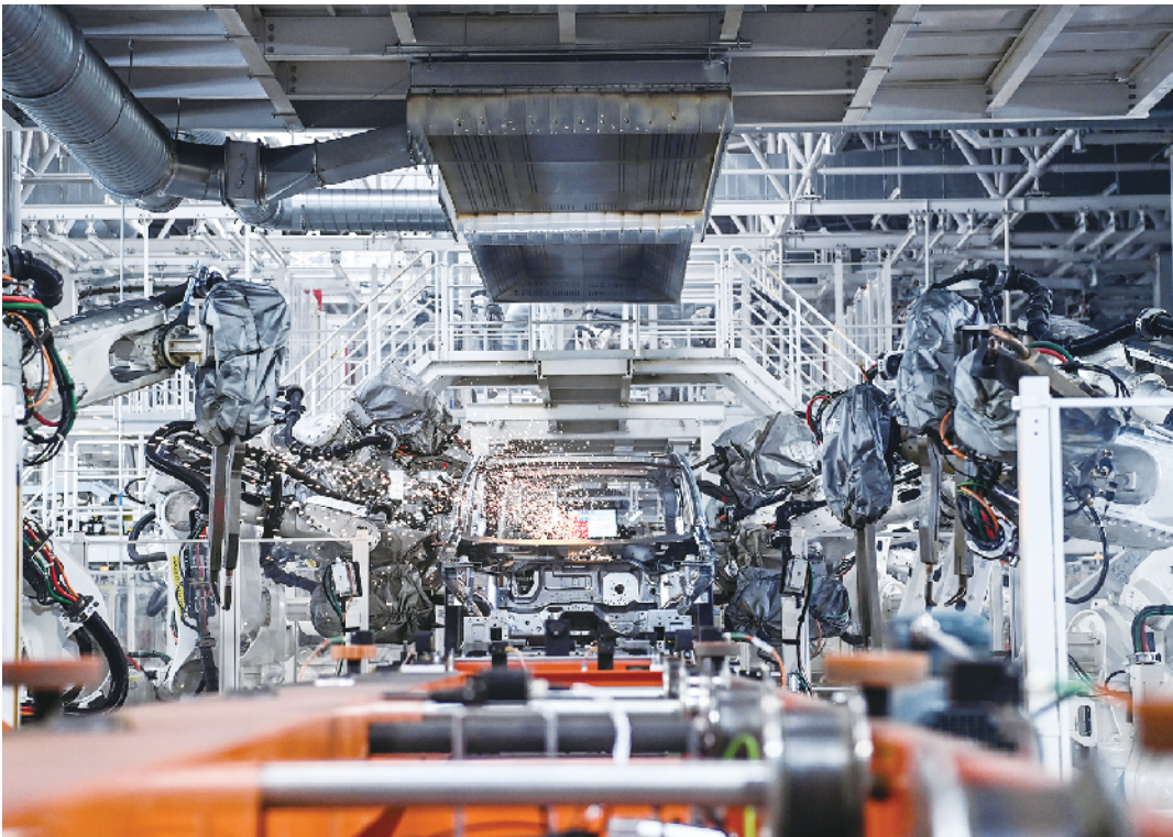
在吉林省长春市一汽红旗繁荣工厂焊装车间内,焊装机器人在生产线上焊接车身。新华社发
